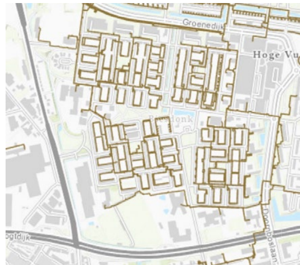
Afbeelding 3.11 Infrastructuur stadsverwarming Biesdonk (bron: Geoweb)
